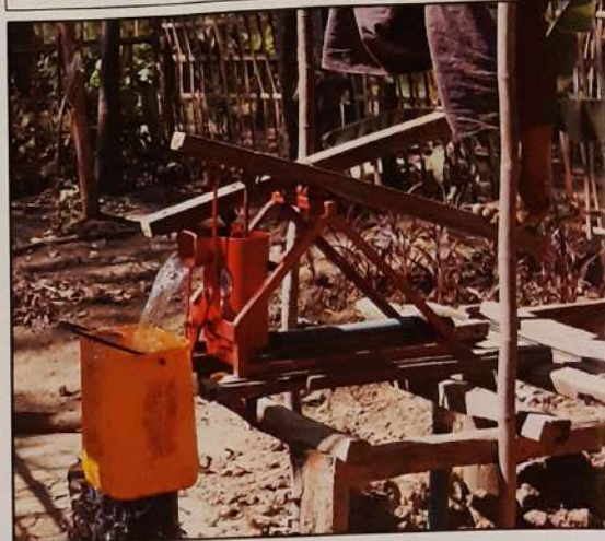
La pompe à pédale Red Rhino de la société Proximity Design en fonctionnement
