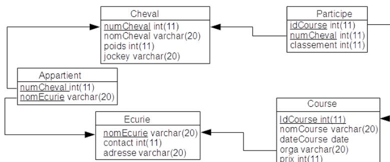
FIGURE 1 – Schéma relationnel de la base.
