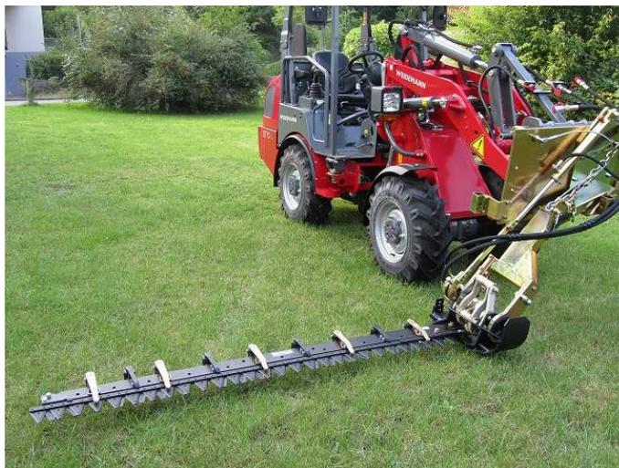
Figure 1 – Véhicule équipé d'une lame de faucheuse
