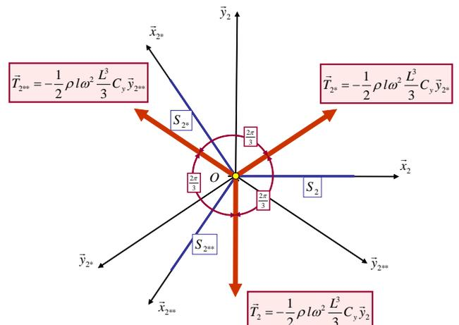
En notant :  $(\vec{T}_2, \vec{P}_2)$ ,  $(\vec{T}_{2^*}, \vec{P}_{2^*})$ ,  $(\vec{T}_{2^{**}}, \vec{P}_{2^{**}})$  les trois couples (trainée, portance) s'exerçant sur ces pales
