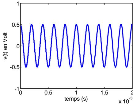
(Noter la fréquence à 5kHz et l'amplitude crête à crête de 1V)
