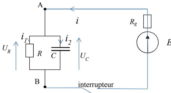
Le condensateur étant initialement déchargé ( $q = 0$ ), à  $t = 0$  on ferme le circuit sur une source réelle de tension, de f.e.m E et de résistance interne  $R_g$ .
